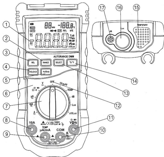
Рисунок 1. Схема мультиметра
